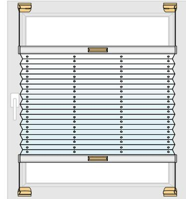
Die auf dem Fensterrahmen geschraubte Montagetechnik mit Winkelträgern kann an allen Fensterarten vorgenommen werden. Erhältlich sind die metallenen Winkel in unterschiedlichen Farben passend zur Auswahl der Profilfarbe. Beim Aufmaß ist darauf zu achten, dass die Plisseeanlage nicht mit Fensterbeschlägen wie dem Fenstergriff kollidiert. Ein seitlicher Überstand von je 1,5 cm pro Seite ist zu empfehlen.
